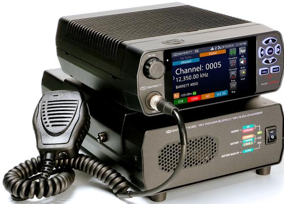
Barrett 4050 HF SDR с блоком питания 4022 в конфигурации базовой станции
